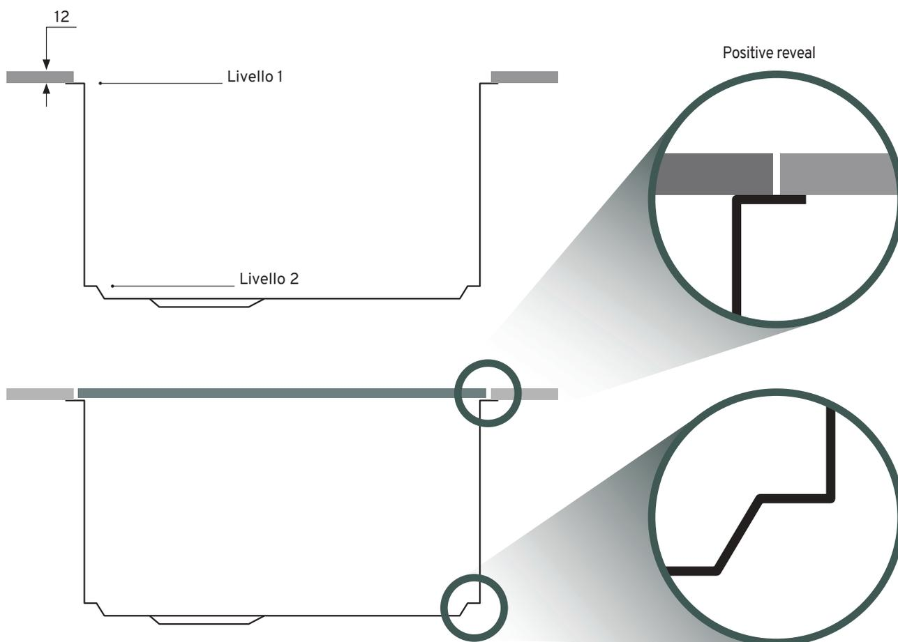
Possibilità di abbinamento delle griglie a filo utilizzando top da 12 mm
