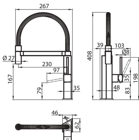
La base del miscelatore ha una forma irregolare, si raccomanda di verificare gli ingombri per l'abbinamento con i lavelli
